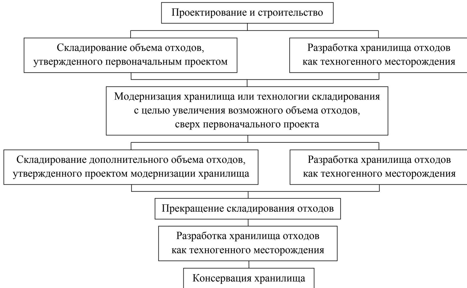
Рисунок 5 – Перспективный алгоритм эксплуатации хранилища отходов
