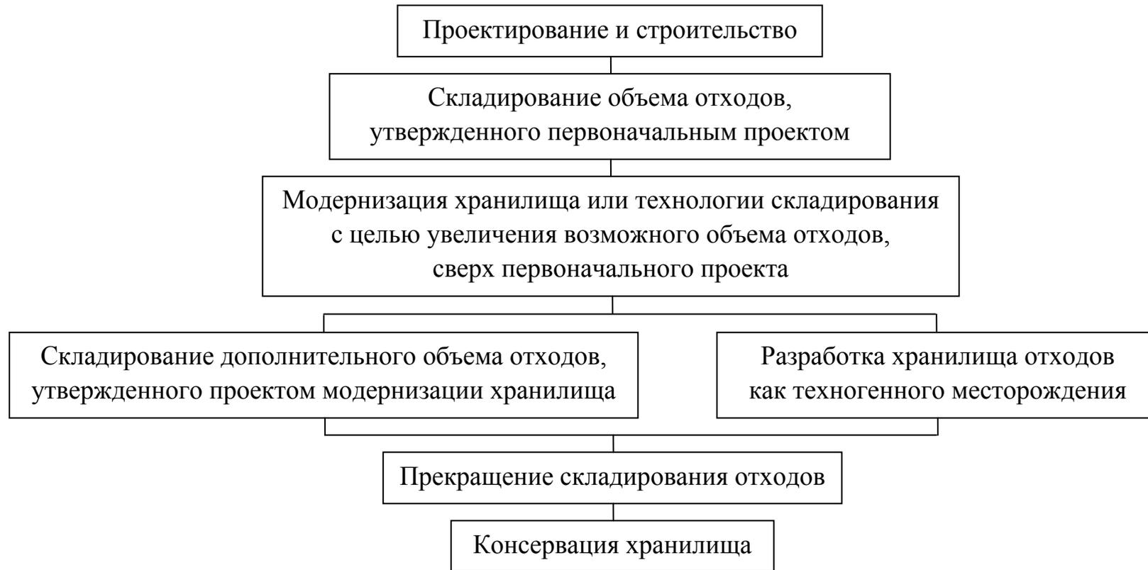
Рисунок 4 – Современный алгоритм эксплуатации хранилища отходов
